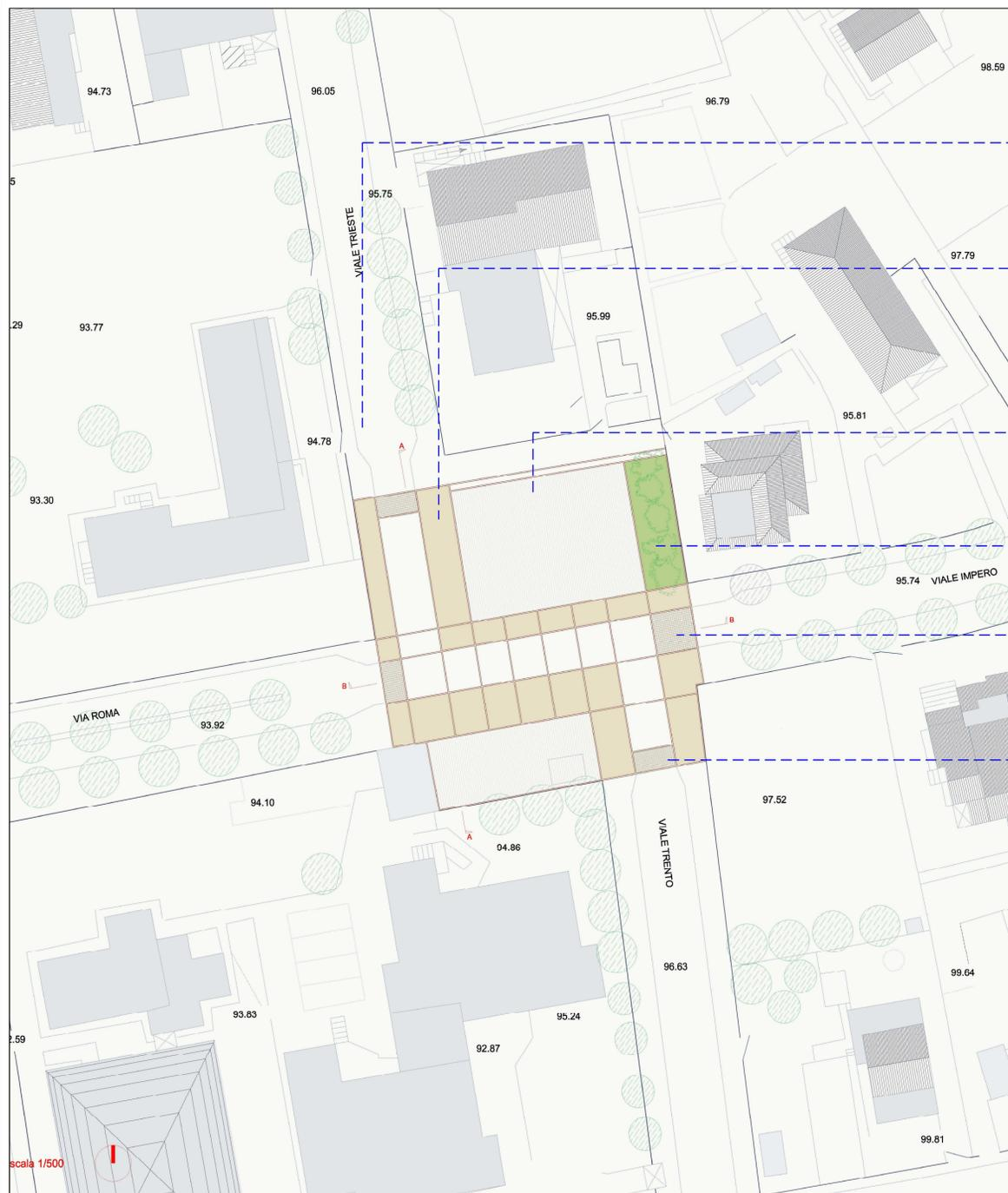
RIDUZIONE DELLA SEZIONE CARRABILE in accesso alla piazza fino alla larghezza di 6m. La funzione dei due tratti viari viene così distinta con l'introduzione della tipologia di traffico misto pedonale / veicolare.
