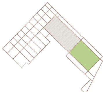
pavimentazione lapidea in lastre di granito + area verde: 620 mq + 350 mq
