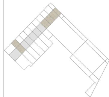
pavimentazione lapidea in tozzetti di granito e asfalto: 180 mq + 230 mq
