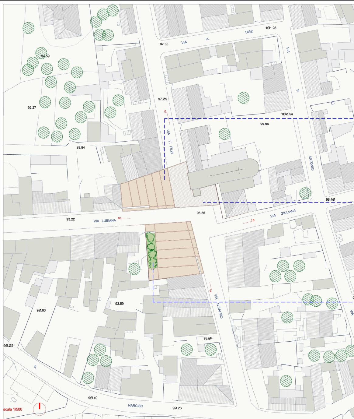
PAVIMENTAZIONE IN IMPASTO tipo Levocell. La strategia adottata è l'eliminazione delle barriere architettoniche adottando la piazza come piano unico e di elevare il livello di attenzione dell'automobilista tramite il cambio delle coordinate materiche della superficie stradale.
